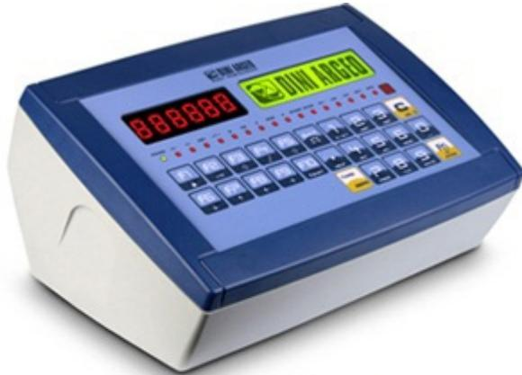
Visor de peso digital de elevadas prestaciones, con entradas y salidas programables, 3 salidas serie, protocolos de transmisión de datos, impresiones totalmente configurables, memoria alibi integrada, pantalla gráfica y entrada por lector de códigos de barras/etiqueta de identificación de serie. La amplia gama de accesorios e impresoras conectables garantiza la máxima configurabilidad y versatilidad. Homologables CE-M (OIML R-76/EN45501).
