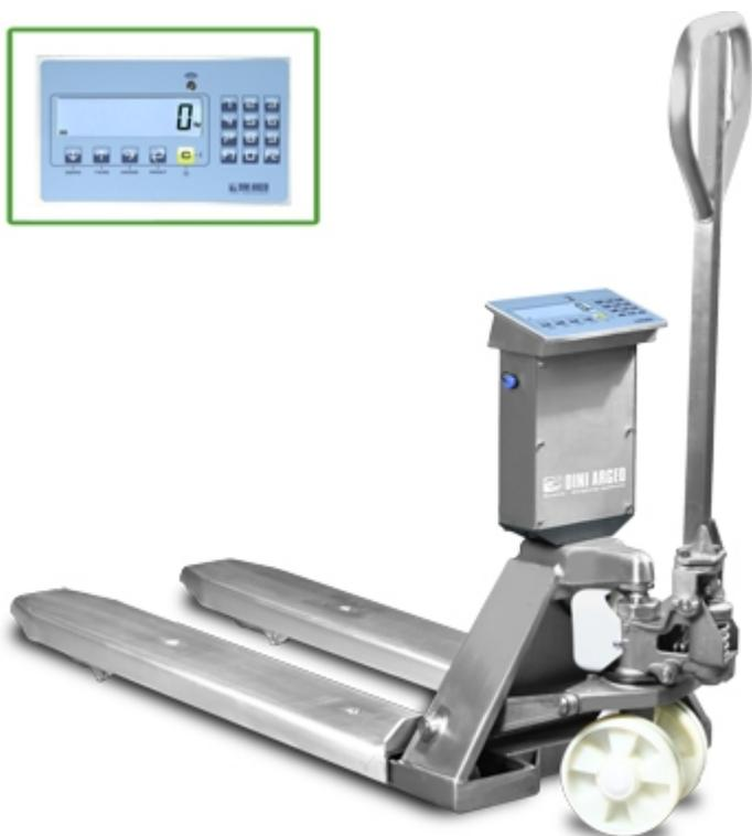
Transpaleta de acero inoxidable con pesaje electrónico multi-rango integrado. Detección de peso por 4 células de carga en acero inoxidable IP68. Fácil de utilizar, robusta y apta para las condiciones pesadas de trabajo. Disponible también en versiones HOMOLOGADAS CE-M.
