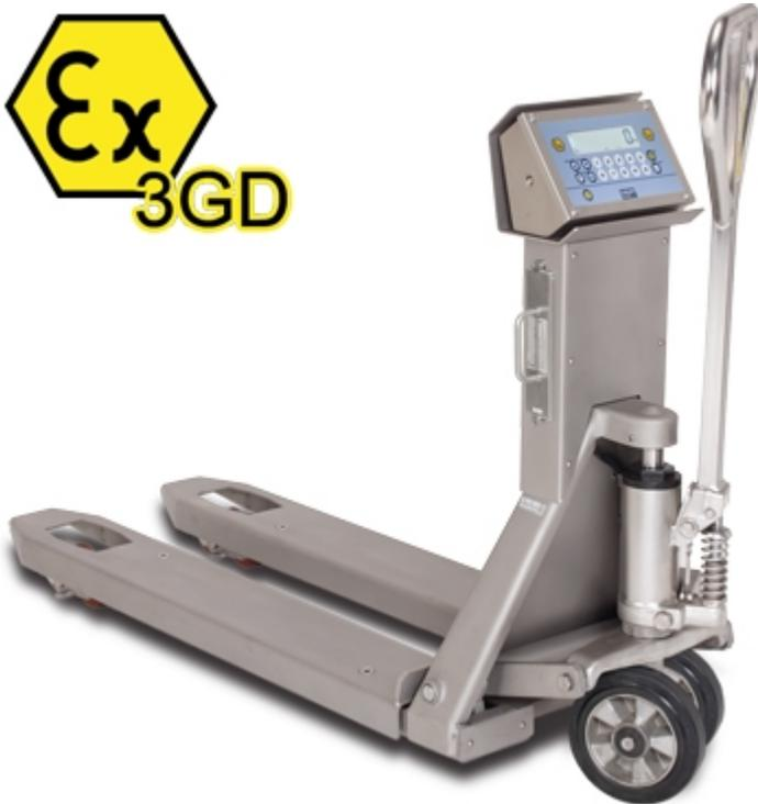
Transpaleta con pesaje electrónico integrado, adecuada para áreas peligrosas clasificadas como zonas con riesgo de explosión (ZONA 2 y 22) con modo de protección según Ex II 3GD IIC T6 T130°C X. La detección del peso por 4 células de carga de acero inoxidable IP68 con certificado ATEX, garantiza la máxima precisión en cualquier condición de trabajo. Estructura completamente de acero inoxidable. Disponible también en versión HOMOLOGADA CE-M.
