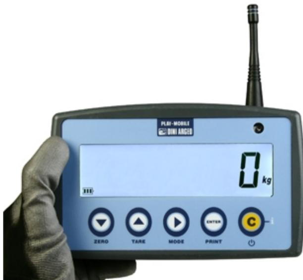
Repetidor de peso por radiofrecuencia para visores serie DFW y dinamómetros MCW, fácil de transportar y visualizar gracias a las dimensiones reducidas y a la pantalla, con grandes cifras, retroiluminada. Permite repetir las principales funciones del gancho gracias al teclado integrado, y almacenar las pesadas para un posterior tratamiento en ordenador mediante comandos via serie o el programa "Weigh Console".
