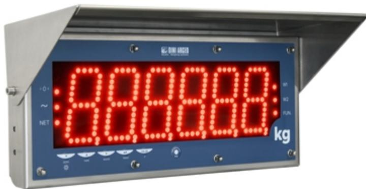
Visor / Repetidor de peso con pantalla de matriz de LEDS de alta intensidad. Apto para el uso en entorno externo, visible aún en plena luz solar y donde es necesario leer el peso a larga distancia y desde cualquier ángulo. Carcasa completamente en acero inoxidable IP68. Aprobado CE-M (OIML R-76 / EN 45501). Aprobado MID (OIML R-61).
