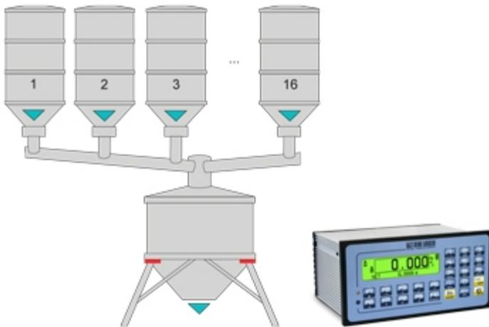
Software de aplicación para visores de peso 3590EXT y CPWE, para sistemas de dosificación automática multi componente y multi balanza.
