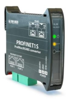
Gracias a la función de Hub, esta interfaz permite controlar vía PROFINET el peso de 16 DGT1S independientes, simplificando la instalación y reduciendo los gastos.
