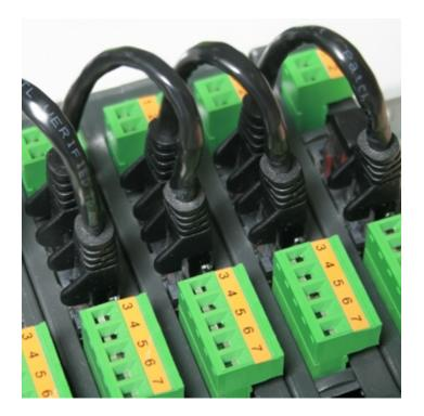
Gracias al sistema Quick Connect, la conexión entre el transmisor de peso DGT1S y la interfaz es simple y rápida.
