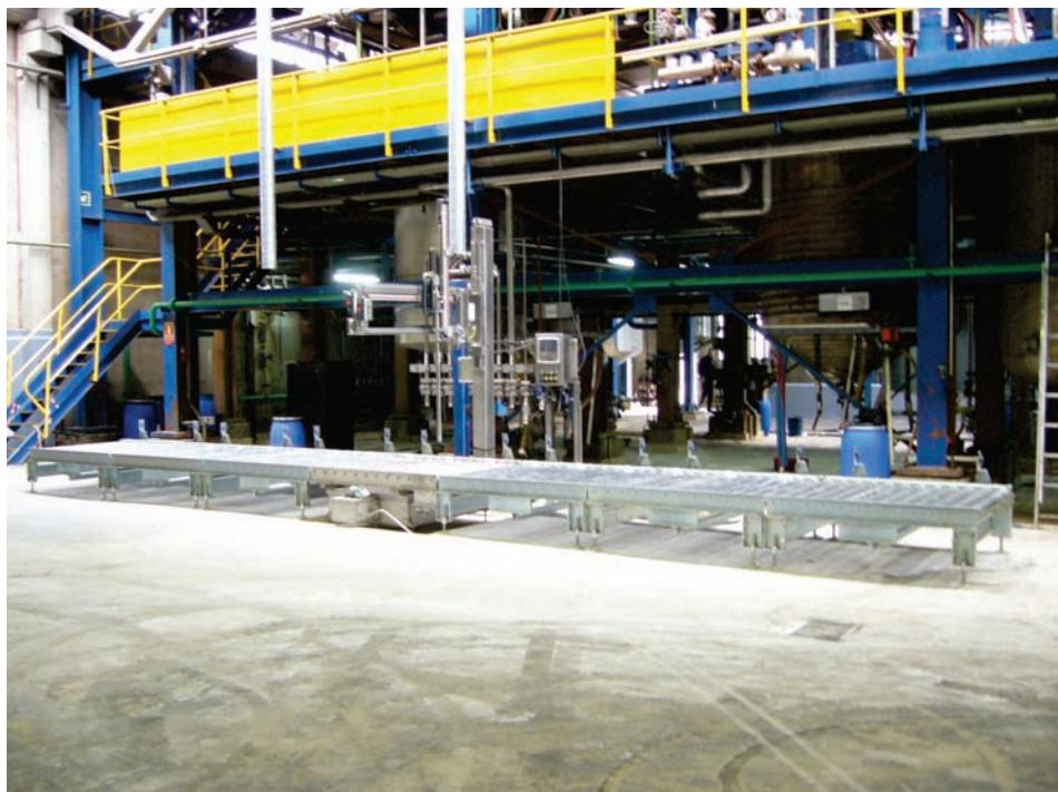
Instalación de caña de llenado con tren transportador automatizado
