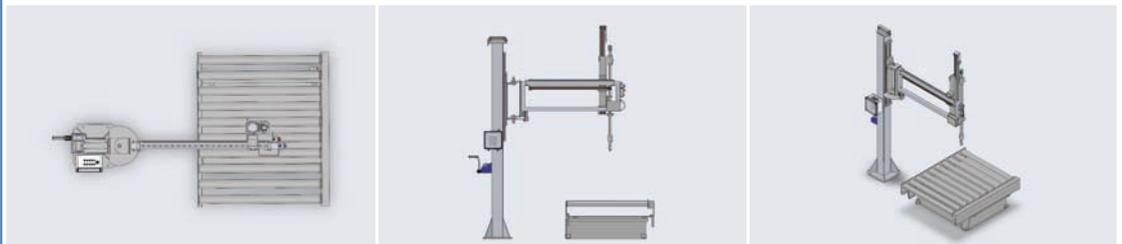
Vistas de un conjunto de caña de llenado con camino de rodillos sobre plataforma de pesaje
