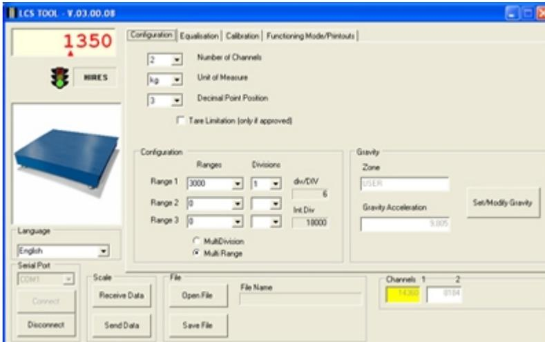
Software gratuito (si se descarga de Internet) que permite la gestión de la configuración de los instrumentos LCS.
