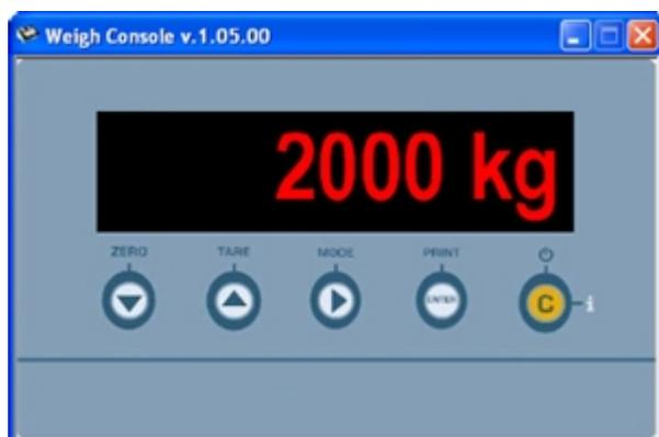
Software gratuito (si se descarga de Internet) que permite de monitorizar desde el PC el peso visualizado en los visores serie DFW, 3590, DGT, DGTO, DGT60, CPW, TRS, TRI.
