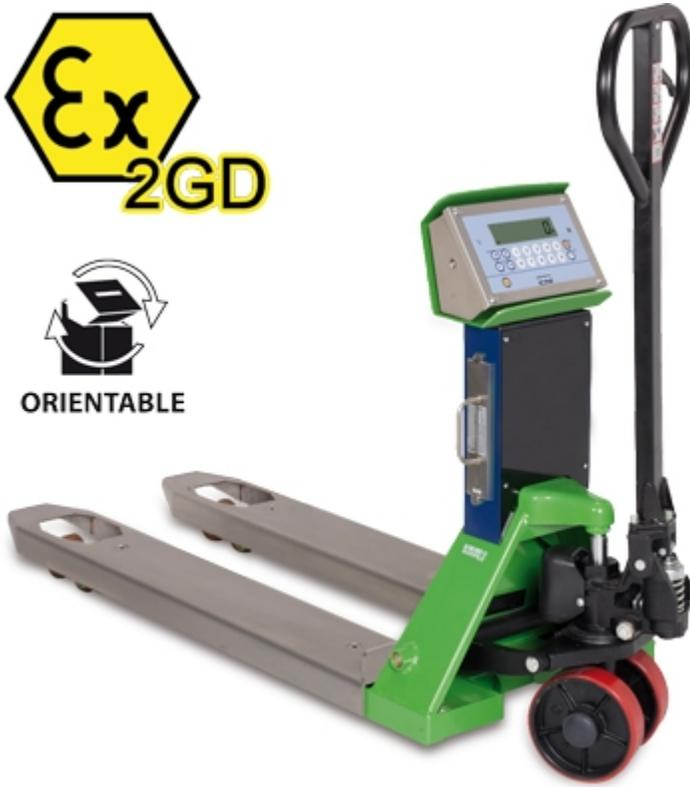
Transpaleta con pesaje electrónico integrado para áreas peligrosas clasificadas como zonas con riesgo de explosión (ZONAS 1 y 21 & 2 y 22) con modo de protección según Ex II 2G IIB T4 T197°C X. La detección del peso por 4 células de carga en acero inoxidable IP68, certificadas ATEX, garantiza la máxima precisión en cualquier condición de trabajo. Disponible también en versión HOMOLOGABLE CE-M.
