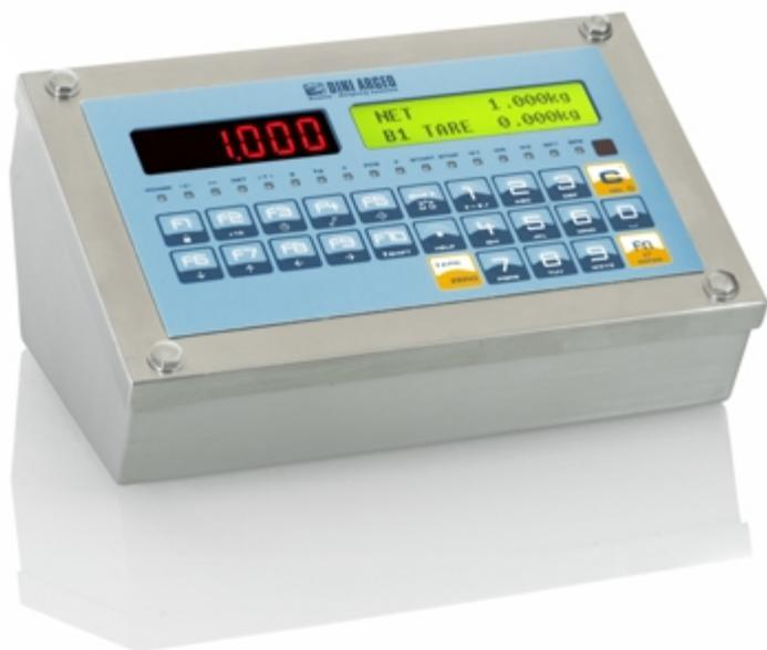
Visor de peso digital de elevadas prestaciones, con 3 salidas serie, protocolos de transmisión datos, impresiones totalmente configurables, memoria alibi integrada y entrada por lector de códigos de barras/etiqueta de identificación de serie. La amplia gama de accesorios e impresoras conectables garantiza la máxima configurabilidad y versatilidad. Homologables CE-M (OIML R-76/EN45501).
