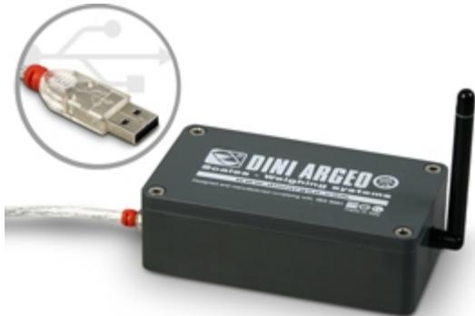
Box interfaz radiofrecuencia 868MHz, para la comunicación sin hilos entre PC/dispositivo master y visor/repetidor de peso. Hasta 50 canales de transmisión, configurables mediante programa sobre el ordenador. Conexión por entrada USB o RS232 (según el modelo).
