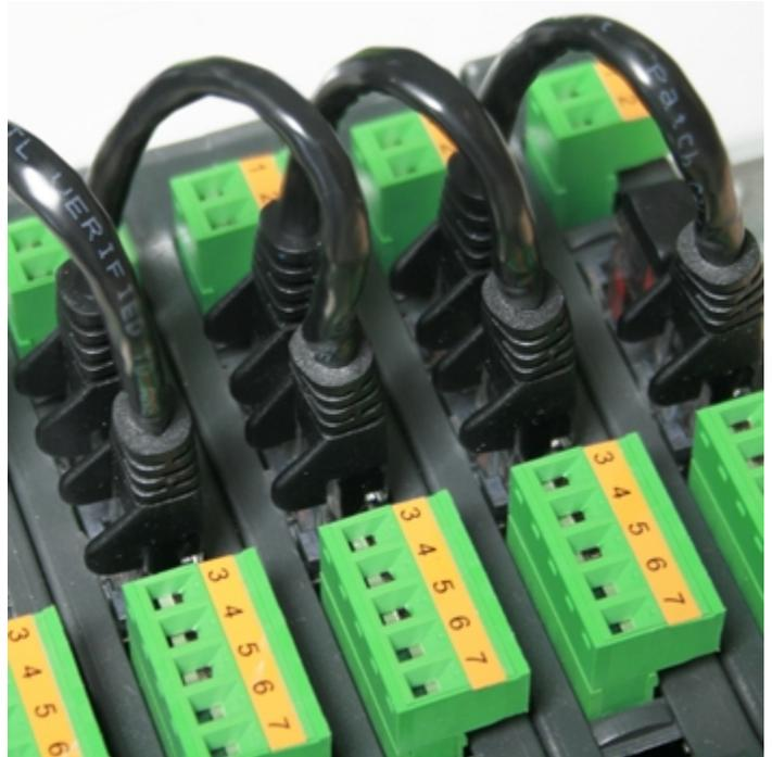
Gracias al sistema Quick Connect, la conexión entre el transmisor de peso DGT1S y la interfaz es simple e rápida.
